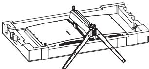
2. Otpustite vijke za montažu, a zatim odvojite vrat s monitora.
