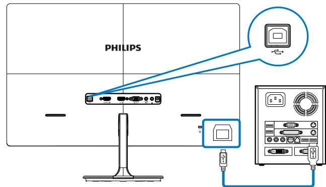
1. Sett USB-kablen fra datamaskinen inn i oppstrøms-USB-kontakten i USB-navet i IU-gruppen på siden av skjermen.
