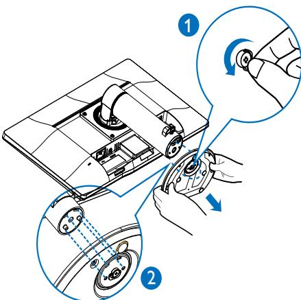
3. Uklonite odvijače s poklopca zgloba.
