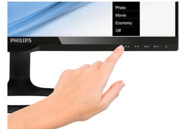
Bedienelemente mit Touch-Technologie sind berührungsempfindliche Symbole, die hervorstehende Tasten ersetzen und dem Benutzer eine individuelle Einstellung des Monitors ermöglichen. Sie reagieren auf leichteste Berührungen und verleihen dem Monitor ein modernes Design.
