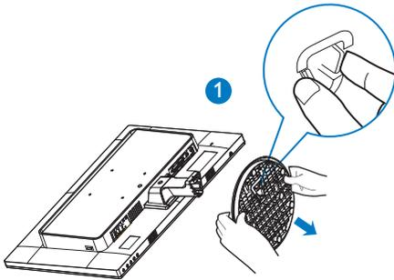
3. Presione el botón de liberación para desmontar la columna de la base.
