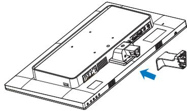
3. Sujete el soporte de la base del monitor con ambas manos e inserte firmemente el soporte de la base en la columna de la misma.
