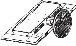
2. Presione los broches de bloqueo para desmontar la base de la col.
