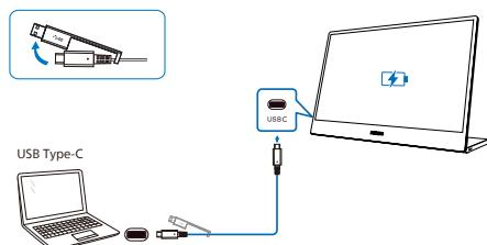
2. 用USB A-C的连接线，将笔记本电脑的USB A端口和显示器连接起来。(拥有E-Mark的连接线，额定电流：5A)
