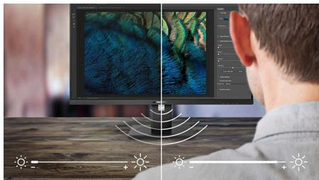
PowerSensor является встроенным "датчиком присутствия", который излучает и улавливает безопасные для человека инфракрасные импульсы, определяет присутствие пользователя и автоматически уменьшает яркость монитора, если пользователь не находится рядом. Эта технология позволяет
