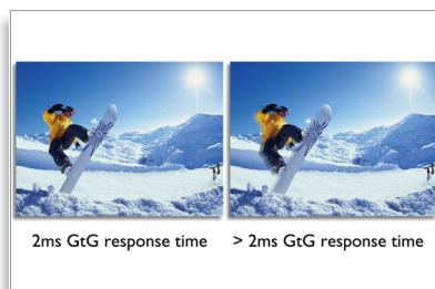
GtG tepki süresi, pikselin bir konumdan diğerine gitmesi için geçen ortalama süre, yani çeşitli rast gele renk seviyesi setleri arasındaki ortalama geçiş süresidir. Bu süre ne kadar hızlı olursa o kadar iyidir: Düşük tepki süreleri, daha hızlı geçişler ve bunun sonucu olarak hızlı hareket eden görüntülerde daha az görünebilir nesne anlamına gelir. GtG film, video ve oyun gibi multimedya içeriğinin görüntü kalitesi konusunda önemli bir ölçütür.
