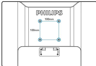
2. Открутите 4 винта и снимите подставку с монитора.
