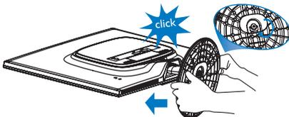
2. Lösen Sie die Schraube an der Basis, ziehen Sie die Basis anschließend vom Monitor ab.
