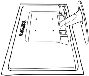
2. Lösen Sie die 4 Schrauben, nehmen Sie die Basis anschließend vom Monitor ab.
