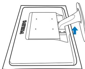
2. Drücken Sie auf die Halteklammern, um den Fuß von der Stütze zu trennen.
