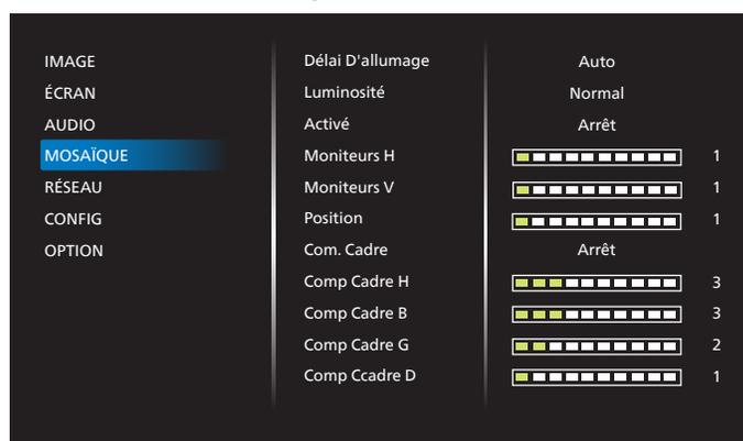
Avec cette fonction, vous pouvez créer une matrice grand écran unique contenant jusqu'à 150 unités de cet écran (jusqu'à 10 unités dans le sens vertical et 15 unités dans le sens horizontal). Cette fonction a besoin d'une connexion en boucle Daisy.
