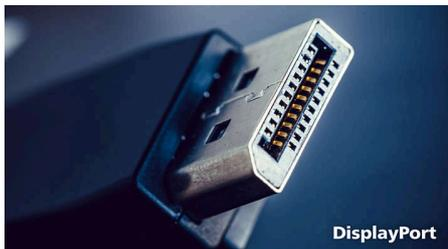
DisplayPort je digitalna veza između računara i monitora, bez konverzije. Uz veće mogućnosti u odnosu na DVI standard, u potpunosti podržava kablove dužine do 15 metara i brzinu prenosa podataka od 10,8 Gb/s. Zahvaljujući visokim
