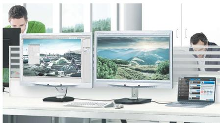
Erweitern Sie Ihren Blickwinkel mit einem einzigen Kabel. Mit einem einzigen USB-Kabel vom Notebook zur Dockingstation können Sie mehrere Monitore über HDMI und DisplayPort anschließen und eine Auflösung von bis zu 4K UHD (3840 x 2160) über die Dockingstation
