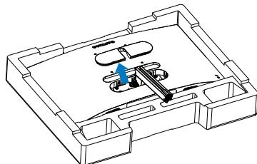
4. Pomoću odvijača uklonite vijke na nosaču, a zatim uklonite nosač/postolje sa monitora.
