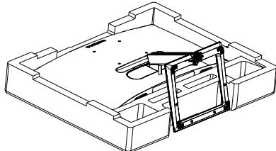
2. Pomoću odvijača otpustite vijak koji se nalazi na dnu postolja i uklonite postolje s nosača.
