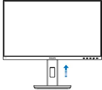
2. 将显示器正面朝下放在平滑的表面上。注意，切勿刮擦或损坏屏幕。接下来，提起显示器底座。
