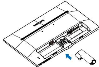
3. Sujete el soporte de la base del monitor con ambas manos e inserte firmemente el soporte de la base en la columna de la misma.
