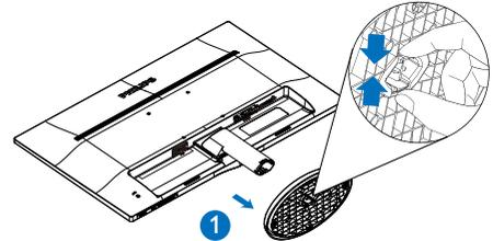
3. Presione el botón de liberación para desmontar la columna de la base.
