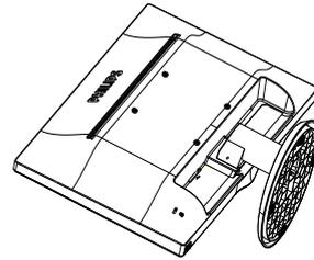
2. Presione los broches de bloqueo para desmontar la base de la col.
