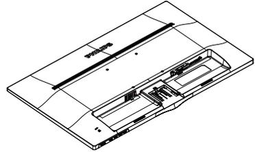
2. Acople la columna de la base al monitor y deslícela de forma que quede encajada en su lugar.
