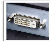
ช่องรับสัญญาณคู่มีช่องเสียบที่รับได้ทั้งสัญญาณเข้าชนิด VGA แบบอะนาล็อกและสัญญาณ DVI แบบดิจิตอล
