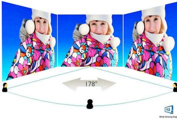
PLS 顯示屏採用進階技術，呈現 178/178 度特寬闊的可視角度，讓您幾乎從任何角度都可看到螢幕內容，使用 90 度旋轉模式效果一樣出眾。PLS 螢幕與標準 TN 螢幕不同，能夠以自然逼真的色彩帶來清脆細膩的圖像，不但適合觀看相片、電影及網絡瀏覽，同時適合用於時刻需要色彩準確度及平穩亮度的專業應用。
