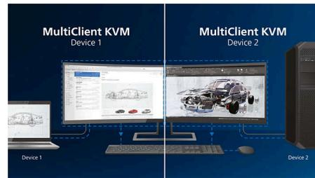
Dengan sakelar KVM Terintegrasi MultiClient, Anda dapat mengontrol dua PC terpisah dengan satu pengaturan mouse-keyboard-monitor. Tombol yang nyaman memungkinkan Anda untuk berganti antar sumber dengan cepat. Praktis untuk pengaturan yang memerlukan daya komputasi dual PC atau berbagi satu monitor besar untuk menampilkan dua PC yang berbeda.
