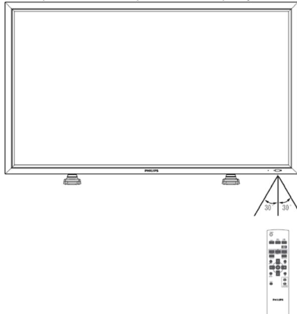
*Примечание: Работа пульта может нарушаться, если датчик сигнала ДУ на мониторе находится под прямыми солнечными лучами или освещается мощными осветителями, а также при наличии препятствий, мешающих прохождению сигнала от пульта ДУ.*
