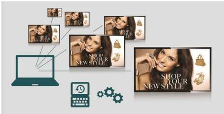
SmartControl te permite controlar de forma remota y gestionar tu red de pantallas a través de RJ45 y RS232C. Fácilmente sintoniza todos los ajustes de la pantalla, incluida la resolución, el brillo, el contraste y la clonación de los ajustes sobre la red completa.
