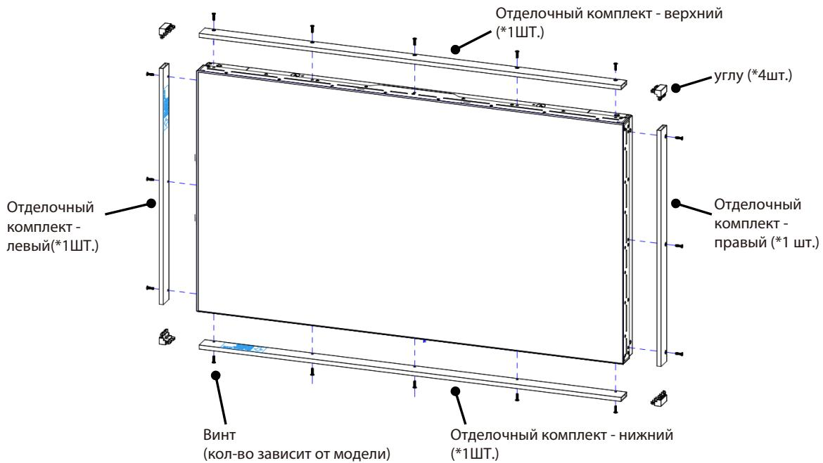
Установка отделочного комплекта для конфигурации 2x2
