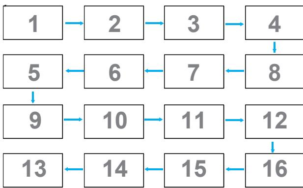
**Примечание.** Для использования этой функции подключите все устройства последовательно с помощью кабеля RS-232 и установите значение RS-232 для их портов сетевого управления.
