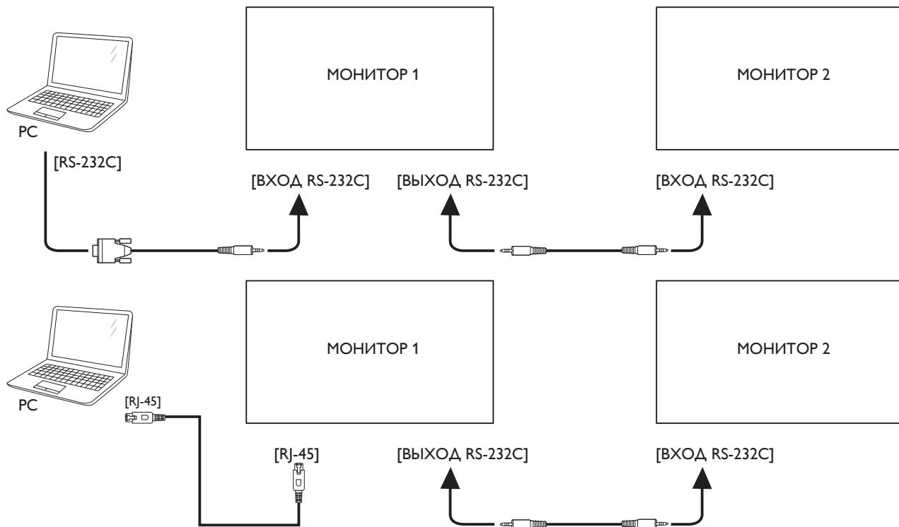
Подключить разъем [RJ-45] ДИСПЛЕЯ 1 к разъему [RJ-45] ДИСПЛЕЯ 2 (коммутатор Ethernet).
