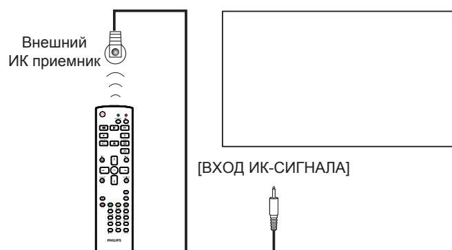
**ПРИМЕЧАНИЕ.** Датчик пульта ДУ монитора не работает при подключении к разъему [ВХОД IR].
