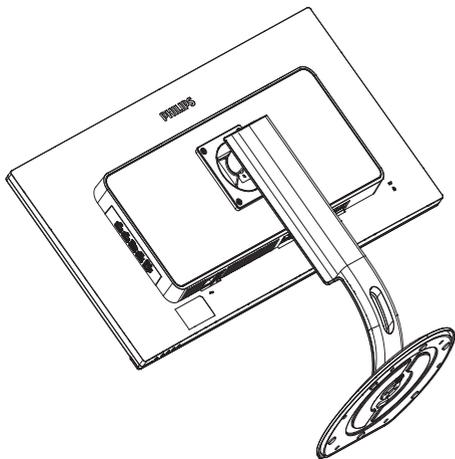
2. Løsne monteringskruene, og ta nakken av fra skjermen.
