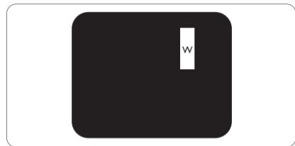
Tre tilstøtende blyste underpiksler (en hvit piksel).
