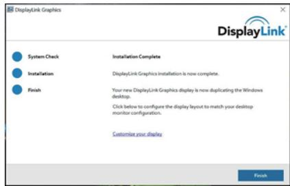
4. После завершения установки потребуется перезагрузить ноутбук для начала использования монитора с док-станцией USB. Чтобы проверить установку, выберите пункт "Отображение адаптеров" в системе. Если отобразится имя монитора, значит, установка ПО DisplayLink завершена успешно.
