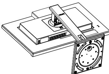
3. Нажав кнопку фиксатора, наклоните основание и извлеките его.
