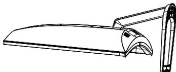
2. Пальцами ослабьте винт с обратной стороны подставки и снимите ее со стойки.
