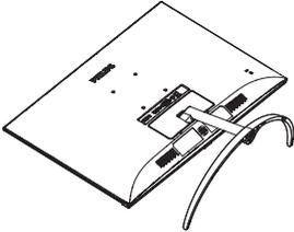
2. Pressione as patilhas de bloqueio para retirar a base da coluna de suporte.
