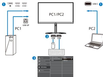
Используйте DP и HDMI в качестве входного сигнала, затем используйте USB-B/USB-C в качестве восходящего USB-порта.
