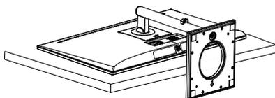
2. Нажав кнопку фиксатора, наклоните основание и извлеките его.
