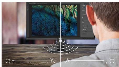
PowerSensor è un sensore integrato che rileva la presenza delle persone. Trasmette e riceve segnali infrarossi non nocivi per determinare l'eventuale presenza di un utente. Se l'utente si allontana dalla scrivania il sensore riduce automaticamente la luminosità dello schermo, riducendo i costi energetici fino all'80% e prolungando la durata di utilizzo dell'apparecchio.
