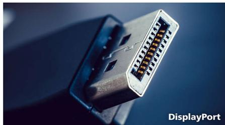
DisplayPort est une interface assurant la liaison numérique sans conversion entre un ordinateur et un moniteur. Ses capacités supérieures à celles de la norme DVI lui permettent la prise en charge de câbles pouvant aller jusqu'à 15 mètres, à des débits atteignant les 10,8 Go/s. De telles performances sans aucune latence sont évidemment le gage de vitesses très élevées en matière de transfert de données et de fréquence de rafraîchissement, ce qui en fait un choix tout
