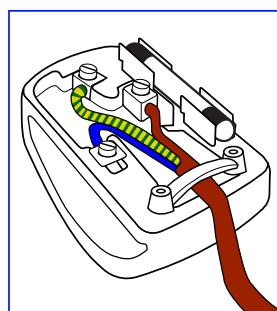
Провода силового кабеля окрашены в соответствии со следующей системой расцветки:
