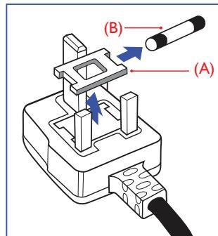
Монитор поставляется в комплекте с литой штепсельной вилкой 13A утвержденного образца. Для замены предохранителя с вилкой этого типа выполните следующие действия:
