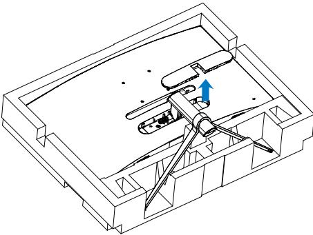
3. 用螺絲起子取下支臂上的螺絲，然後從螢幕拆下支臂／支架。
