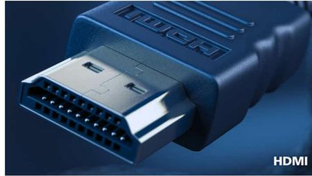
Un dispositivo compatible con HDMI tiene todo el hardware necesario para admitir una entrada de interfaz multimedia de alta definición (HDMI). Un cable HDMI permite transmitir audio y vídeo digitales de alta calidad a través de un solo cable desde un ordenador o desde fuentes AV (incluidos sintonizadores, reproductores de DVD, receptores de A/V y cámaras de vídeo).
