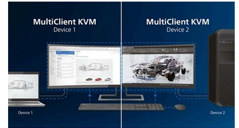
Mit dem integrierten Multiclient-KVM-Switch können Sie zwei separate PCs mit einem Monitor-Tastatur-Maus-Setup bedienen. Eine praktische Taste ermöglicht den schnellen Wechsel zwischen den Signalquellen. Besonders praktisch bei Setups, die doppelte PC-Rechenleistung erfordern, oder zur gemeinsamen Nutzung eines großen Monitors für die Anzeige von zwei verschiedenen PCs.
