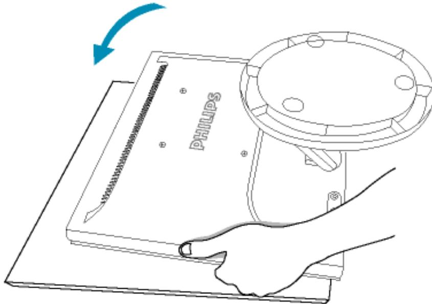
1) Coloque el monitor boca abajo sobre una superficie segura.
