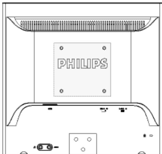
**Observación:** Este monitor admite sistemas de montaje VESA de 100 x 100 mm.
