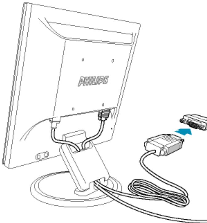
**Observación:** Si el equipo es Apple Macintosh, deberá conectar el adaptador especial para Mac a un extremo del cable de señal del monitor.
