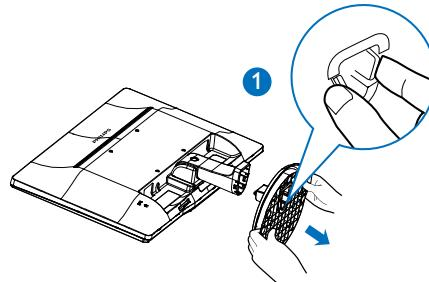
3. Presione el botón de liberación para desmontar la columna de la base.
