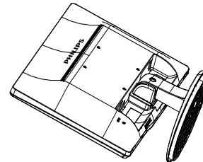
2. Presione los broches de bloqueo para desmontar la base de la col.
