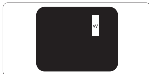
Tre sammenliggende tændte pixler (en hvid pixel)
