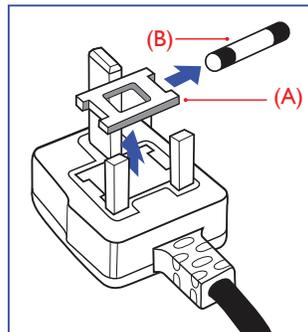
Dieses Gerät wird mit einem geprüften angegossenen 13-A-Stecker geliefert. Gehen Sie zum Austauschen einer Sicherung bei diesem Steckertyp wie folgt vor:
