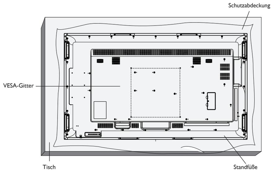
1. Legen Sie die Schutzabdeckung, die bei Lieferung um das Anzeigegerät gewickelt war, auf einem Tisch unter der Bildschirmoberfläche aus, damit der Bildschirm nicht zerkratzt.
