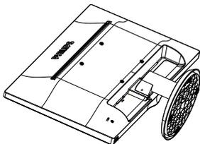
2. Нажмите фиксаторы, чтобы отсоединить подставку монитора от основания.
