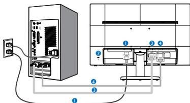
3. Подсоедините сигнальный кабель монитора к разъему «видео» на обратной стороне компьютера.
