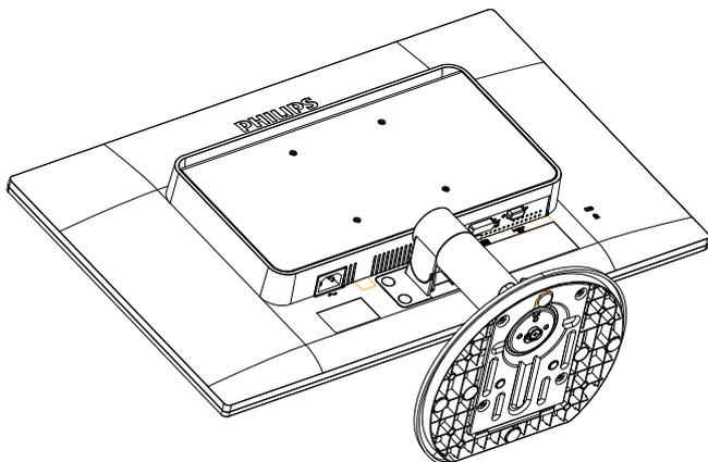
2. Χρησιμοποιήστε ένα κατσαβίδι επίπεδης κεφαλής για να αφαιρέσετε τέσσερα μπιλάρ από το κάλυμμα του αρμού.
