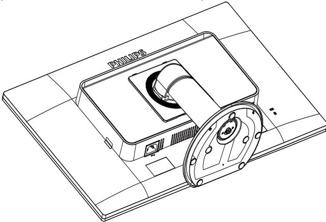
2. Utilice un destornillador plano para quitar los cuatro elementos Mylar de la tapa de la bisagra.
