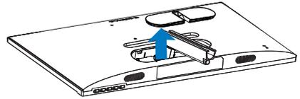
4. 使用螺丝刀卸下支撑臂上的螺丝，然后从显示器分离支撑臂 / 支架。
