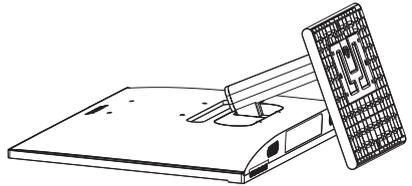
2. (1) 用螺丝刀拧开位于底座底部的螺丝。
