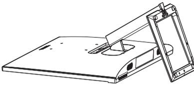
2. 用螺丝刀拧开位于底座底部的螺丝，从底座上拆下显示器。
