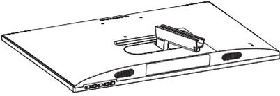
2. (1) 用双手拿住底座支撑臂，用力将底座支撑臂插入底座支撑柱。
