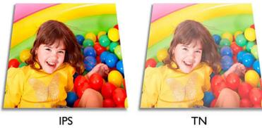
IPS 顯示屏採用先進技術，呈現更寬闊的 178/178 度可視角度，讓您幾乎從任何角度 - 即使是 90 度旋轉模式，均可觀看顯示屏。IPS 顯示屏與標準 TN 屏幕不同，能夠以自然逼真的色彩帶來清脆細膩的圖像，不但適合觀看相片、電影及網絡瀏覽，同時適合用於時刻需要色彩準確度及平穩亮度的專業應用。
