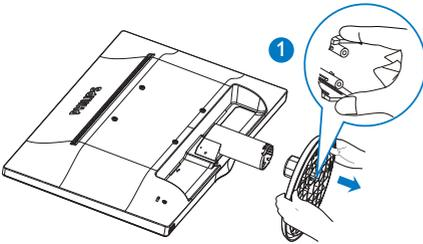
3. Presione el botón de liberación para desmontar la columna de la base.
