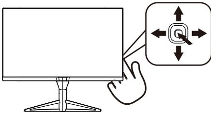
Para acceder al menú OSD de esta pantalla Philips simplemente tiene que utilizar el botón de cambio único situado en la parte inferior del marco de la pantalla. El botón único opera como un joystick. Para mover el cursor, simplemente accione el botón en cuatro direcciones. Presione el botón para seleccionar la opción que desee.
