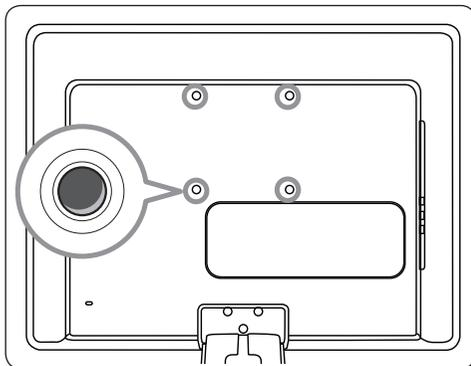
2. Richten Sie die Platte/Halterung an den vier Befestigungsmuttern aus und platzieren Sie die Abstandsscheiben zwischen die Platte/Halterung und die Befestigungsmuttern.
