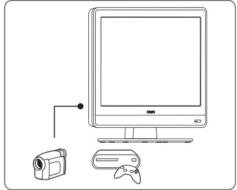
Verwenden Sie die seitlichen Anschlüsse, um tragbare Geräte wie einen HD-Camcorder oder eine Spielkonsole anzuschließen. Sie können auch einen Kopfhörer anschließen.
