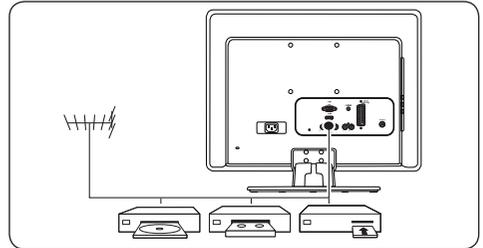
Verwenden Sie die Anschlüsse auf der Rückseite, um die Antenne und feste Geräte wie HD-Disc-Player, DVD-Player oder Videorecorder anzuschließen.
