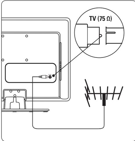
2. Schließen Sie ein Ende des Antennenkabels (nicht mitgeliefert) an den Anschluss **TV ANTENNA** an. Verwenden Sie einen Adapter, falls das Antennenkabel nicht passen sollte.
