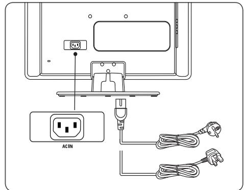
2. Schließen Sie das Netzkabel an den Anschluss **AC IN** an.
