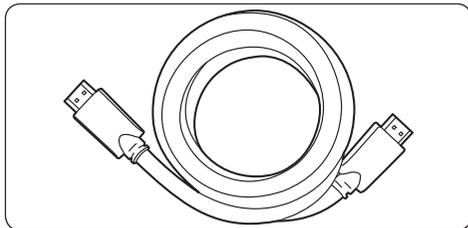
HDMI erzeugt die bestmögliche audiovisuelle Qualität. Audio- und Videosignale werden in einem HDMI-Kabel kombiniert. HDMI stellt eine unkomprimierte, digitale Schnittstelle zwischen Ihrem Fernsehgerät und HDMI Geräten bereit. Sie müssen HDMI verwenden, um ein High-Definition-Video in höchster Auflösung wiederzugeben. Außerdem müssen Sie HDMI-Kabel wie in *Abschnitt 7.5, „Verwendung von Philips EasyLink“*, beschrieben zur Aktivierung von Philips EasyLink verwenden.
