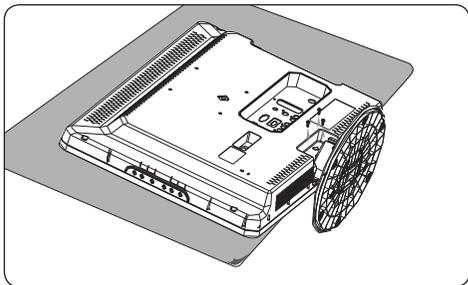
3. Ziehen Sie den Standfuß von der Unterseite ab. Bewahren Sie Standfuß und Bolzen an einem sicheren Ort für eine spätere Wiederverwendung auf.
