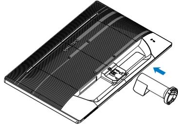
3. Tenez le support du socle du moniteur avec deux mains et insérez fermement le support du socle dans la colonne du socle.
