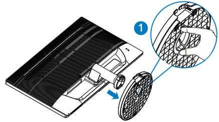
3. Appuyez sur le bouton de détachement pour détacher la colonne de base.
