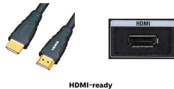
Un dispositivo HDMI-Ready dispone di tutto l'hardware necessario per accogliere un ingresso High-Definition Multimedia Interface (HDMI). Un cavo HDMI consente segnali audio e video digitali di alta qualità trasmessi su un
