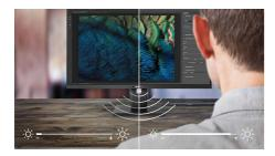
PowerSensor является встроенным "датчиком присутствия", который излучает и улавливает безопасные для человека инфракрасные импульсы, определяет присутствие пользователя и автоматически уменьшает яркость монитора, если пользователь не находится рядом. Эта технология позволяет снизить энергопотребление на 80 % и значительно увеличить срок службы монитора
